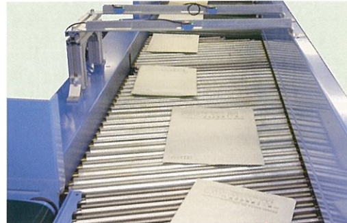
●幅寄せコンベヤ部 (傾倒装置)
